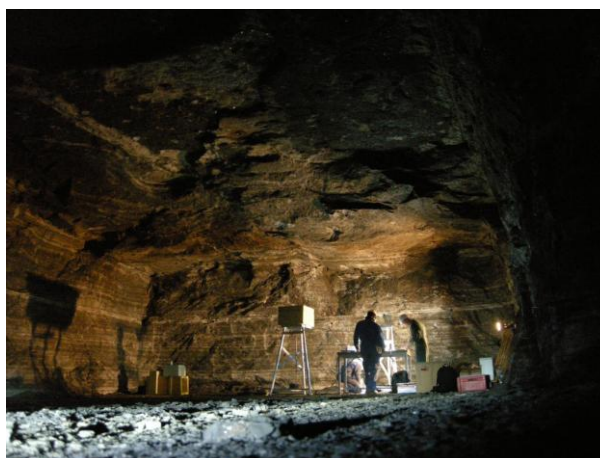
Installation de bâtis de fluage dans une galerie en cul-de-sac de la mine de Varangéville
